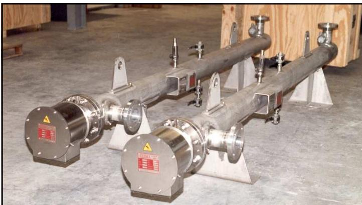
2 Réchauffeurs d'eau 200 Kw, tout inox, construits selon code ASME, pour le chauffage à 100°C de cuves de stockage en centrale nucléaire /
